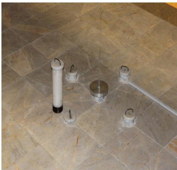
شکل ۲. الف) محل قرارگیری آشکارسازها و چشمه‌ی ^{241}\text{Am-Be} در حین پرتودهی؛ ب) محل قرارگیری چشمه‌ی ^{241}\text{Am-Be} در زمین.
