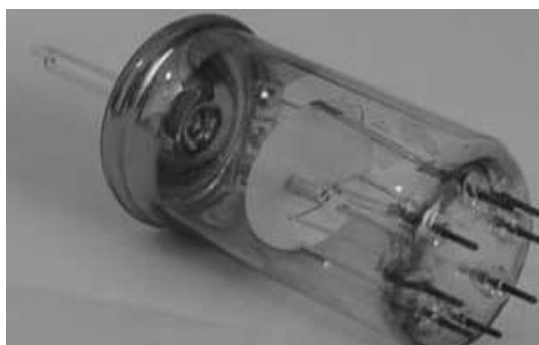
شکل ۲- دیود خلاء برای تست کاتد.
