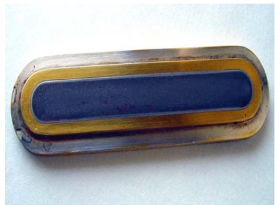
شکل ۱- نمونه‌ای از هدف تالیوم آماده شده که بر روی زیرلایه مسی لایه‌نشانی شده است.
