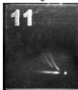
شکل ۷. ظهور ردهای سهمی شکل در آشکارساز CR-۳۹، (الف) آزمایش ۳، (ب) آزمایش ۴، (ج) آزمایش ۵.
