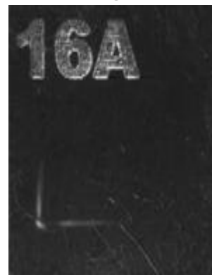
شکل ۵. (الف) ایجاد ردی خطی‌شکل بر روی آشکارساز CR-39 بعد از یک شات با اعمال تنها میدان الکتریکی، (ب) ایجاد دو منحنی سینوسی-مانند بر روی آشکارساز CR-39 بعد از دو شات پی در پی با اعمال تنها میدان مغناطیسی، (ج) تصویر خط‌های عمودی و افقی حاصل از اعمال میدان الکتریکی و مغناطیسی به صورت مجزا در طیف‌سنج تامسون بعد از حفاظ‌گذاری الکترومغناطیسی.
