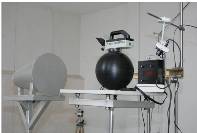
تصویری از مخروط سایه طراحی و ساخته شده و پیکربندی مورد استفاده در اندازه‌گیری دُز نوترون‌های پراکنده شده در آزمایشگاه کالیبراسیون نوترون پژوهش‌گده تحقیقات کشاورزی، پزشکی و صنعتی.
