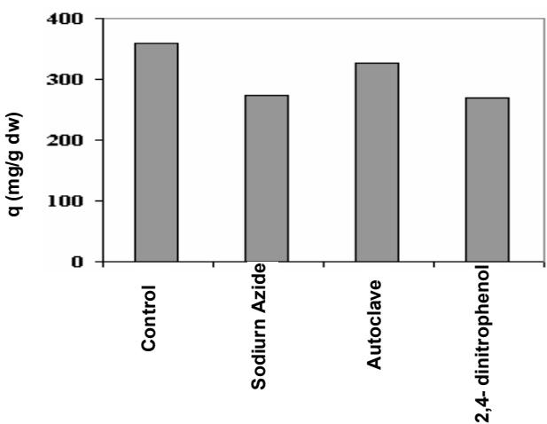
اثر مهارکننده‌های متابولیکی سدیوم آزید، اتوکلاو و ۲،۴-دی‌نیتروفنل بر روی جذب تنگستن توسط *Bacillus* sp. MGG-83 pH برابر با ۲، غلظت تنگستن برابر با  $300\text{ mg/l}$ ، دما برابر با  $30^{\circ}\text{C}$  و هوادهی ۱۵۰ دور در دقیقه.
