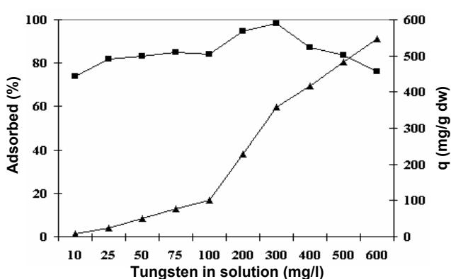
اثر غلظت تنگستن موجود در محیط بر جذب تنگستن توسط *Bacillus* sp. MGG-83 (pH برابر با ۲، دما  $30^{\circ}\text{C}$ ، زمان مجاورت ۹۰ دقیقه و هوادهی ۱۵۰ دور در دقیقه، ■ نشان‌دهنده درصد جذب تنگستن و ▲ نشان‌دهنده مقدار جذب ویژه تنگستن است).
