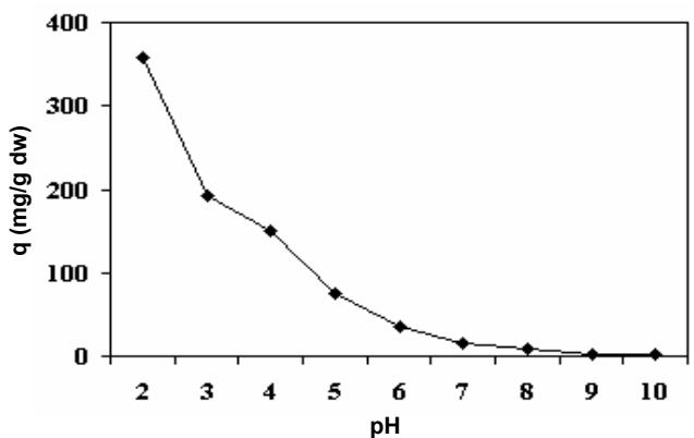
اثر pH بر جذب تنگستن توسط *Bacillus* sp. MGG-83 (دما برابر با  $30^{\circ}\text{C}$ ، غلظت تنگستن برابر با ۳۰۰ میلی گرم بر لیتر، زمان مجاورت ۹۰ دقیقه و هوادهی ۱۵۰ دور در دقیقه).
