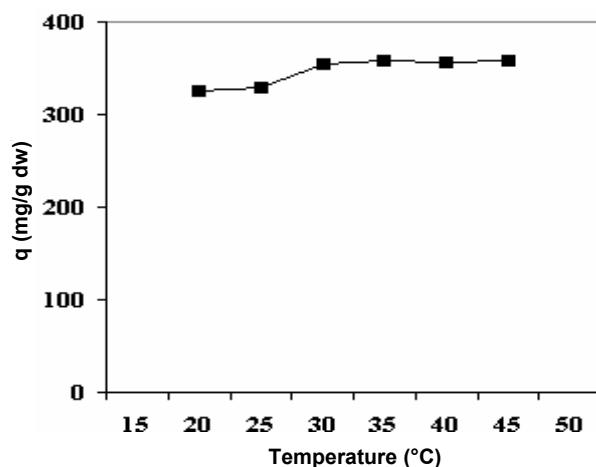
اثر دمای محیط بر جذب تنگستن توسط *Bacillus* sp. MGG-83 (pH برابر با ۲، غلظت تنگستن برابر با  $300$  میلی‌گرم بر لیتر، زمان مجاورت  $90$  دقیقه و هوادهی  $15^{\circ}\text{C}$  دور در دقیقه).
