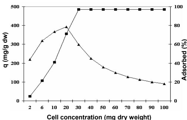
اثر مقدار توده سلولی بر جذب تنگستن توسط *Bacillus* sp. MGG-83 pH برابر با ۲، غلظت تنگستن برابر با  $300\text{ mg/l}$ ، دما برابر با  $30^{\circ}\text{C}$ ، زمان مجاورت ۹۰ دقیقه و هوادهی ۱۵۰ دور در دقیقه، ■ نشان دهنده درصد جذب تنگستن و ▲ نشان دهنده مقدار جذب ویژه تنگستن می‌باشد.
