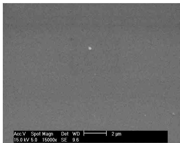
شکل ۳- تصویر SEM زیرلایه سیلیسیوم پوشیده شده با نیکل به روش کندوپاش یونی.
