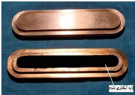
شکل ۱- نمونه‌ای از هدف‌های متداول در سیکلوترون (آبکاری Zn بر روی زیرلایه مسی)
