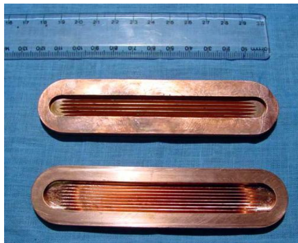
شکل ۳- تغییرات اعمال شده در ابعاد و تعداد شیارهای پشت نگهدارنده
