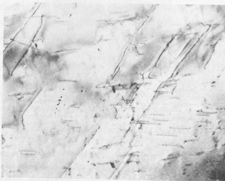
شکل ۳ - مثالی از شکل جابجایی‌های تشکیل شده در الیاژ \text{Ni}_3\text{Ge} پس از تغییر شکل پلاستیکی الیاژ. همانطور که مشاهده می‌شود جابجایی‌ها تکی و دوتایی است و از نقص روی هم چینی اثری نیست.
