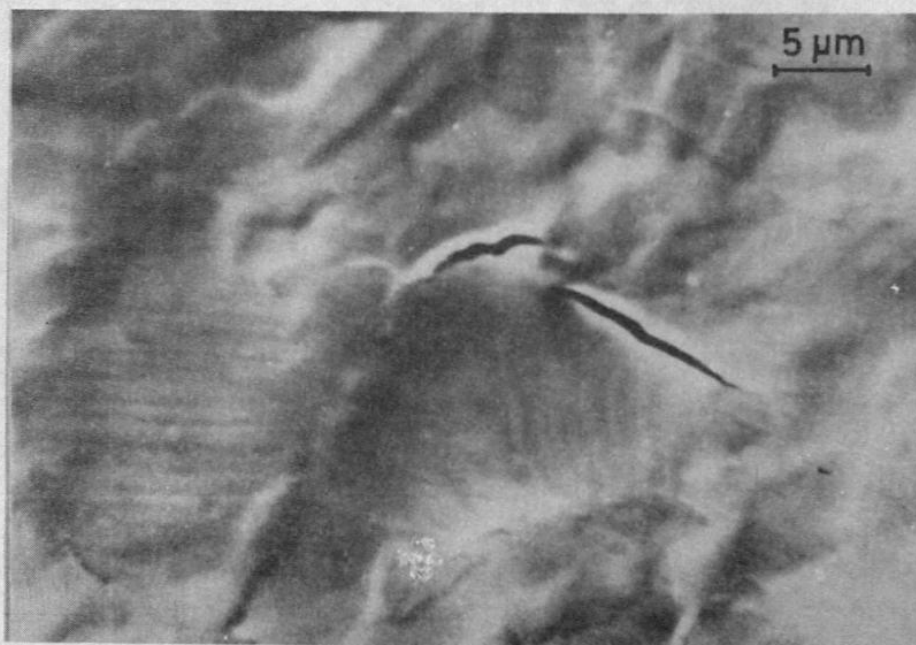
شکل ۸ - عکس بادرشت نمائی زیاد که توسط میکروسکپ الکترونی از یک نمونه فولاد زنگ نزن ۳۱۶ که هیجده بار در معرض برخورد با پلاسما قرار گرفته برداشته شده است. در این عکس ترک سطحی به خوبی مشخص می باشد.
