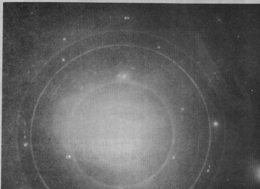
شکل ۱-۳ دیفراکسیون الکترون آلیاژ ۱۱۰۰ که به مدت ۹۰ ساعت در آب 50^{\circ}\text{C} بوده است L = 76\text{ Cm} و ولتاژ شتاب دهنده الکترون ۸۰ کیلوولت بوده است. \lambda = 0.0418\text{ \AA}
