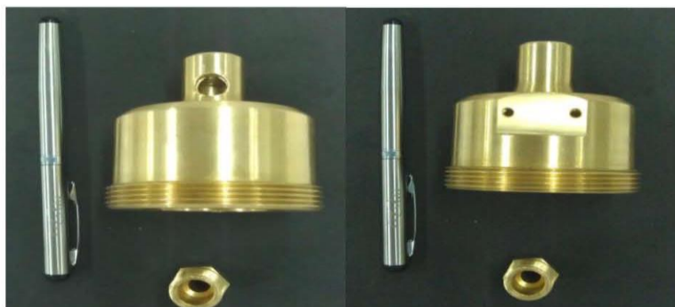
شکل ۸. نگه‌دارنده‌ی هدف مایع از جنس برنج.
